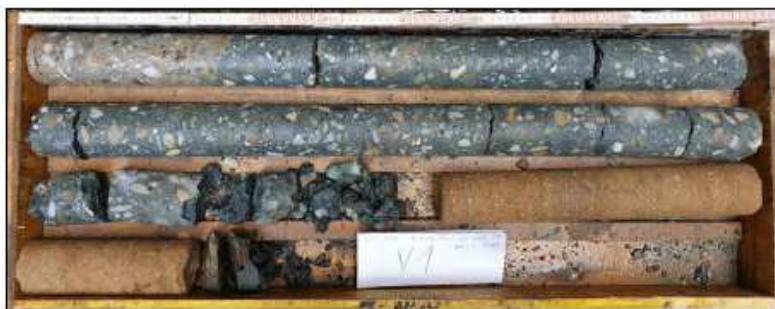
Obr. č. 1 - diagnostický vrt V1
